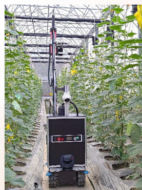
自主移動智慧病蟲害辨識精準噴藥機巡場情形
