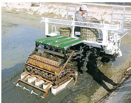
野蓮種植機田間測試情形
