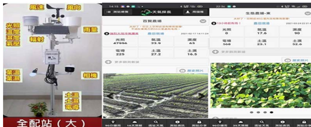
圖 4. 輔導示範場域百賢及宗和兩家農場在外銷毛豆生產專區導入智能型影像監測系統 10 台，即時監測大農場毛豆植株生長情形，並掌控農田微氣象資料
