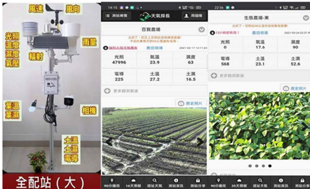
圖3. 輔導示範場域百賢及宗和兩家農場在外銷毛豆生產專區導入智能型影像監測系統10台，24小時監測大農場毛豆植株生長情形，並即時掌控農田微氣象資料。
