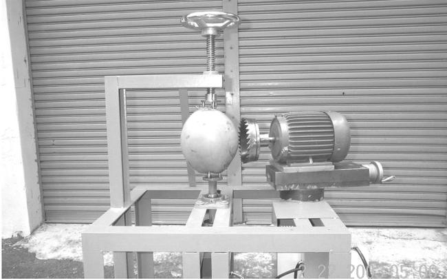
圖 11.椰子剝殼機械示意圖
