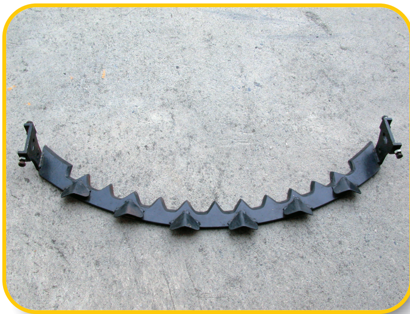
▲圖9. 鋸齒形挖掘刀外觀
