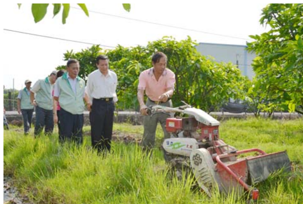
蔡順得班長現場操作經該產銷班與農機商合作改良兼具割草功能的碎枝機
