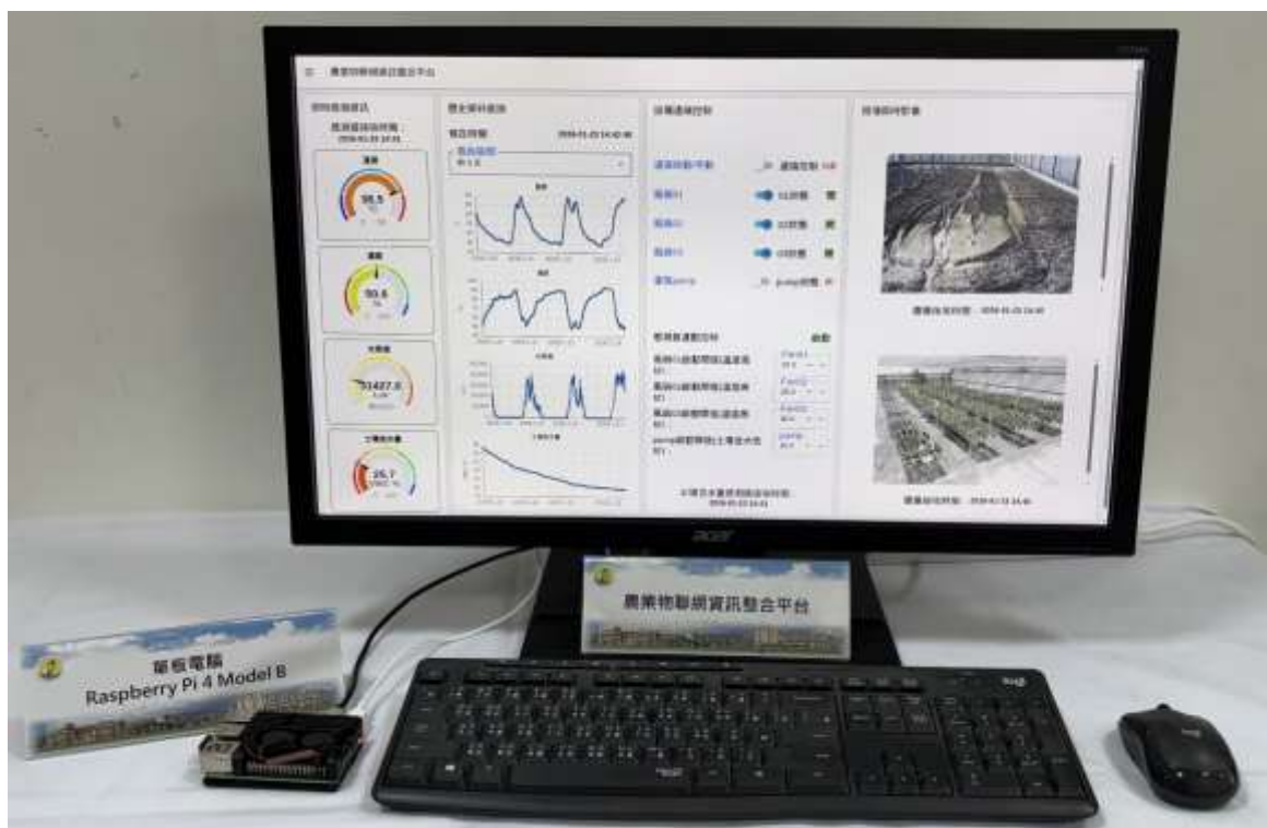
圖 3. 使用單板電腦建立農業物聯網資訊整合平台
