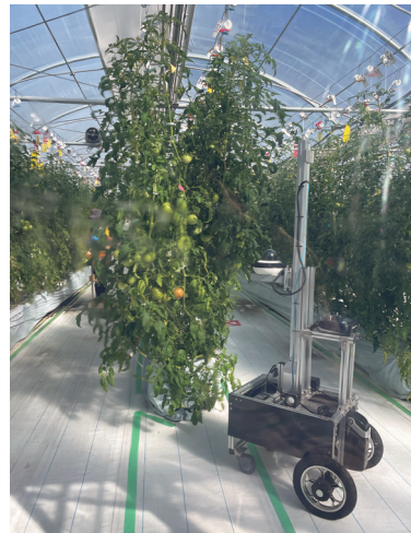
圖3. NTT東日本示範場域，於番茄溫室應用機器人影像蒐集系統。
