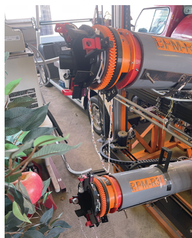
圖1. 筑波大學研發的蘋果自動採收之機器手臂
