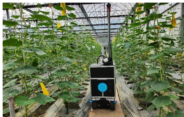
自主移動智慧病害辨識精準噴藥機
