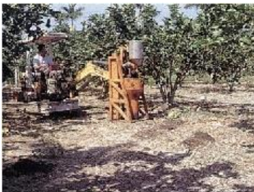
圖 1 小型挖土機承載之果樹立體施肥機
