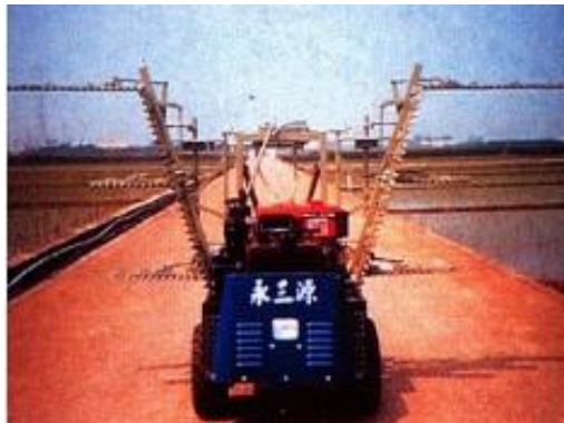
圖 22 荔枝樹型修剪用機械
