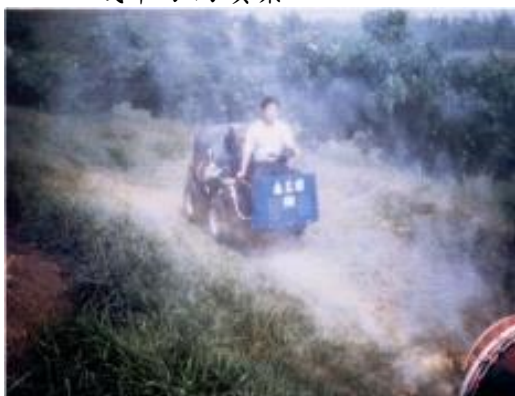
圖 15 適於坡地行走之四輪驅動四輪轉向鼓風式施藥車
