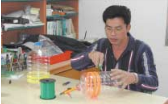
圖一. 用美工刀將保特瓶(5000cc)切開成上下兩部份
