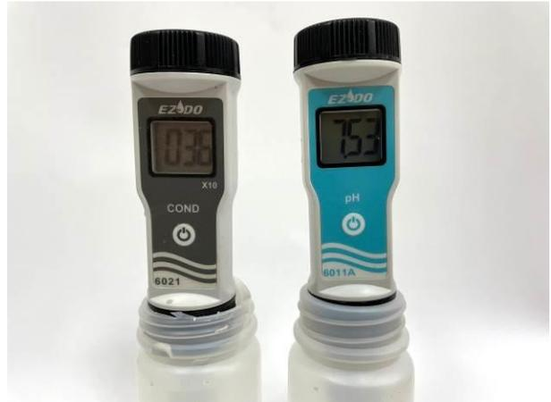
灌溉水基本參數可經由市售簡易式酸鹼度計及電導度計初步判斷
