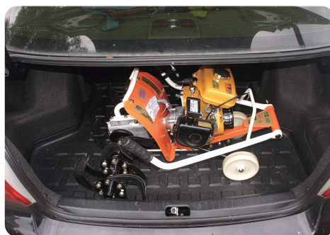
圖2. 無輪式中耕管理機收折後可放置於後車廂
