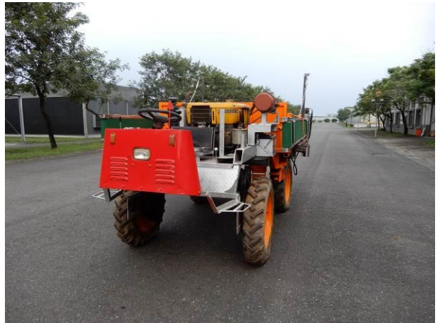
輸送帶折疊後鳳梨收穫輔助機械外觀
