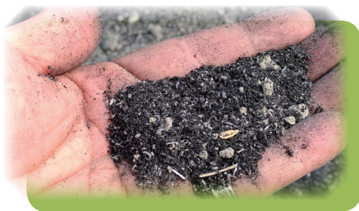
圖 3. 稻殼灰炭主要為稻殼經高溫 (700°C) 限氧燒製後的產物
