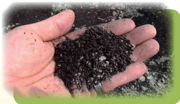
圖 4. 稻殼燻炭為稻殼低溫 (300°C 以下) 限氧燻燒而成
