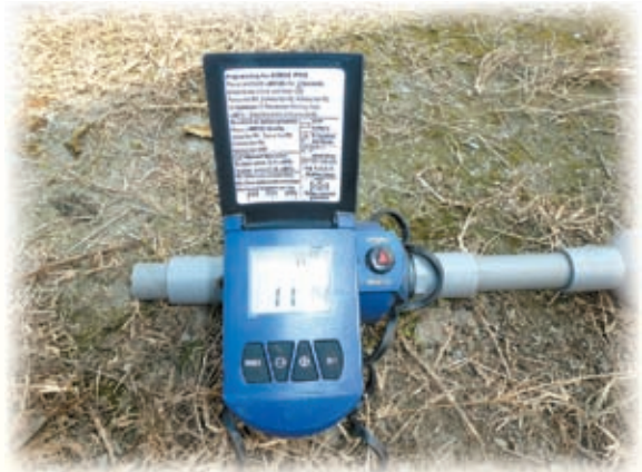
▲圖19.直流電電磁閥配備單區控制器
