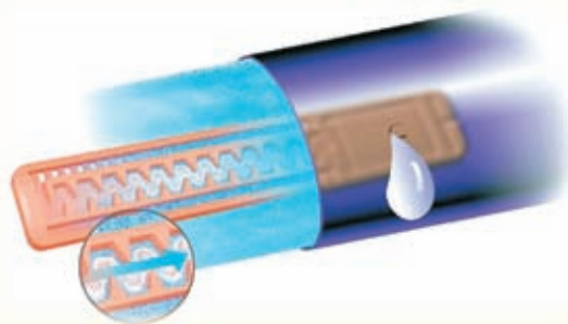
▲圖11. 滴灌管構造示意圖(取自Netafim)
