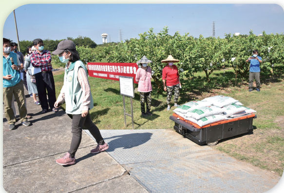
負重爬坡情形
