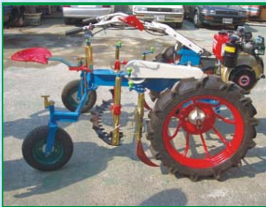
圖2.自走式洋蔥挖掘機
