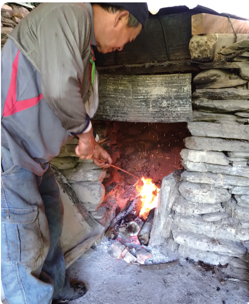
圖4. 烤窯設計內部由窄到寬由低到高，坑洞前端火口燃燒柴火時，熱量能均勻分散至後方以儲存熱氣。（何雅婷提供）
