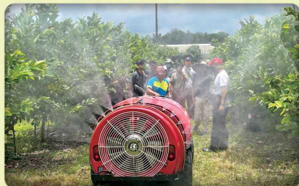
使用馬力較強的噴藥車，有效霧化藥液兼顧有效、省藥及省工。
