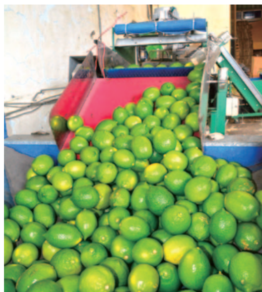
▼圖29、利用蔬果清潔拋光機清理果皮表面
