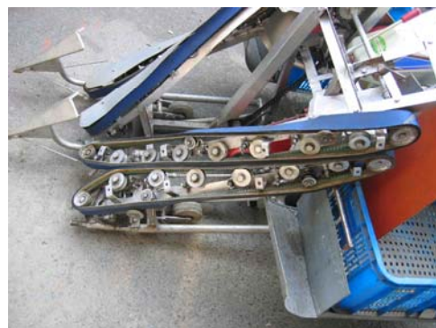
圖 4. 旋轉送料式挾持機構
