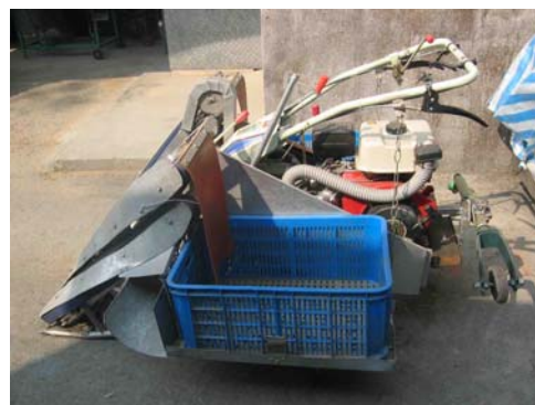
圖 2. 研製旋轉送料式收割機外貌
