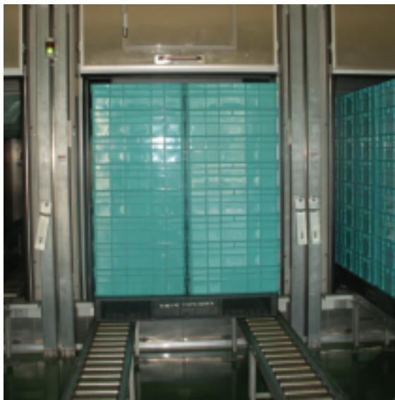
▲左鎮外銷蒸熱場的蒸熱設備，淺綠色塑膠籃內裝木瓜，由堆高機推入蒸熱庫中。
