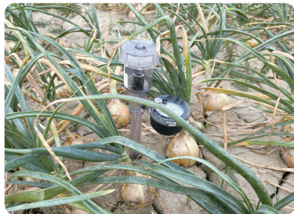
圖2. 田間埋設水分張力計監測土壤水分狀況
