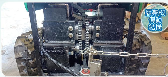
履帶機傳動結構
