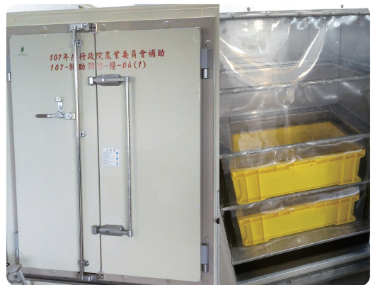
圖5. 小型的蒸熱處理器，取代溫湯處理機，以抑制炭疽病發生。
