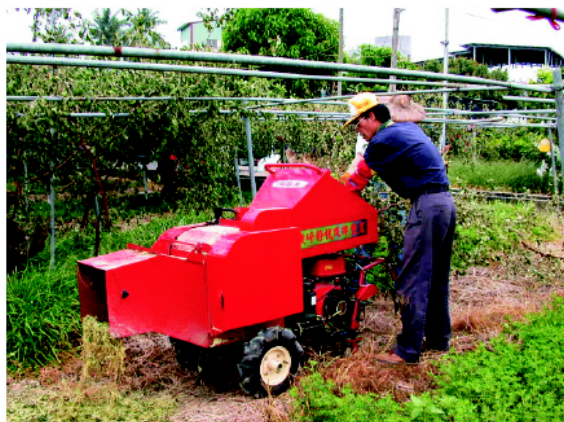
▲圖 3. 本粉碎機粉碎印度棗殘枝情形
