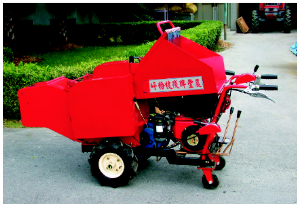
▲圖 1. 果樹殘枝粉碎機之側面結構
