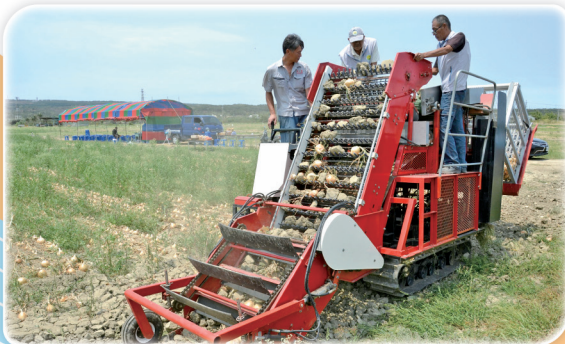
洋蔥採收機械田間作業情形
