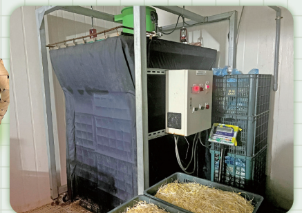
使用頂吸式壓差預冷機將芽菜預冷
