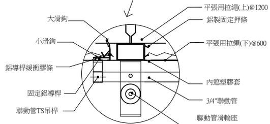
內遮蔭設備驅動系統剖面示意圖
