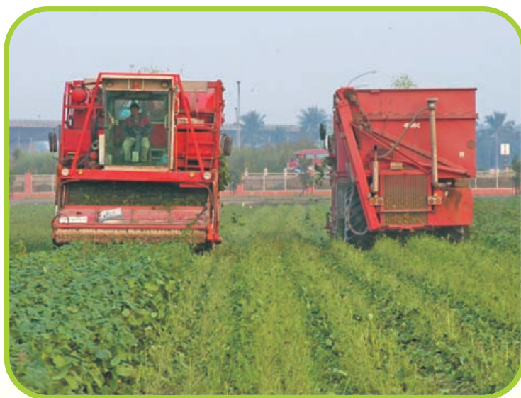
▲ 圖 6. 毛豆新品種高雄 9 號（綠晶）之機械化採收
