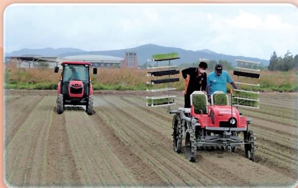
乘坐式洋蔥移植機種植作業情形
