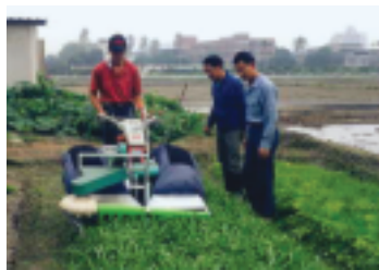
▲圖3. 小葉菜收割機田間作業情形
