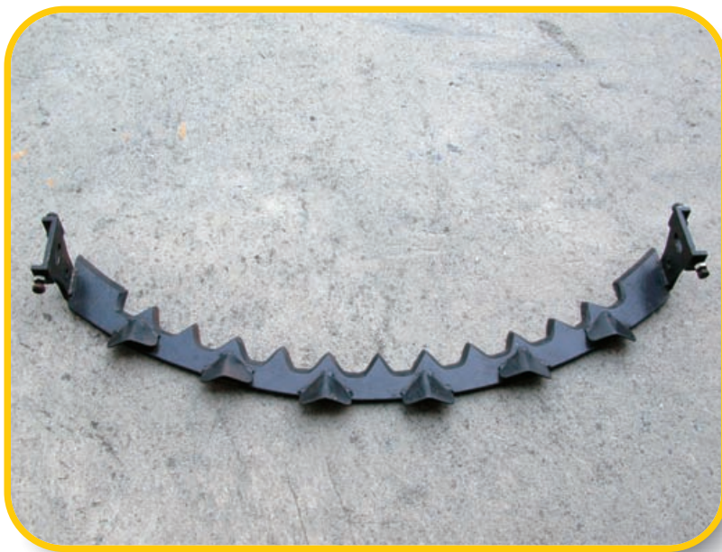
▲圖9. 鋸齒形挖掘刀外觀
