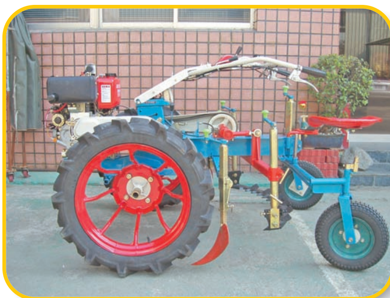
▲ 圖8. 自走式洋葱挖掘機側視
