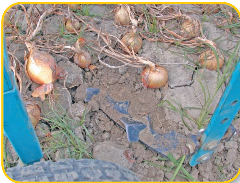
▲ 圖 11. 挖掘刀深入葱球根部下破裂土壤
