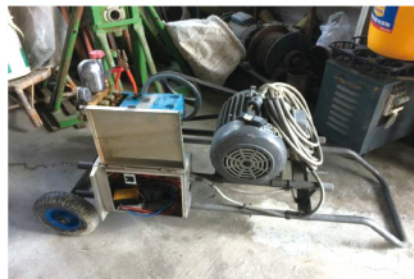
圖2. 許班長訂製的高壓噴霧機推車，可輕鬆移動。
