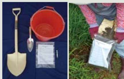
▶圖22、果園常見之土壤採樣工具 (由左至右分別為圓鍬、移植鏝、乾淨的水桶、採樣袋及油性筆
